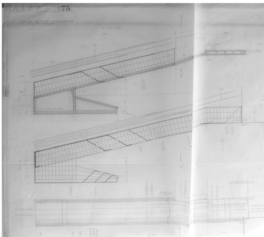
Plan n° 73: fondations de l'escalier-rampe et armatures contre-cœur en béton
