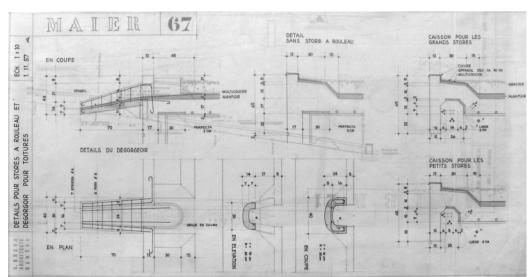
Plan n° 67: détail évacuation eaux de toiture, détail dalle avec intégration stores
