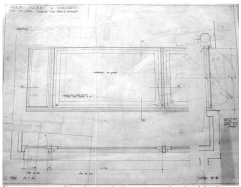
Plan sans n°: stores à lamelles dans le pivotant et store à rouleau à l'extérieur
